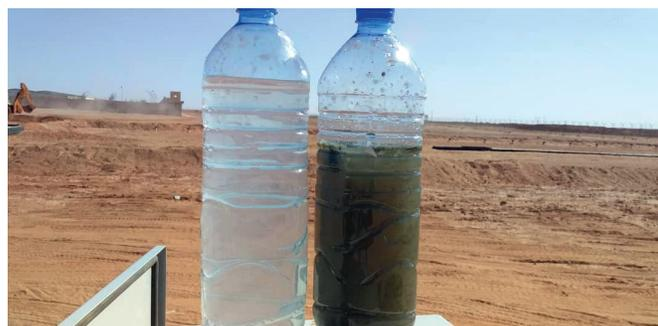
La clarté de l'effluent System O)) comparé à l'affluent
