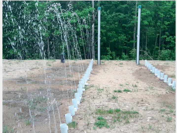
Calibración de inyectores de baja presión
